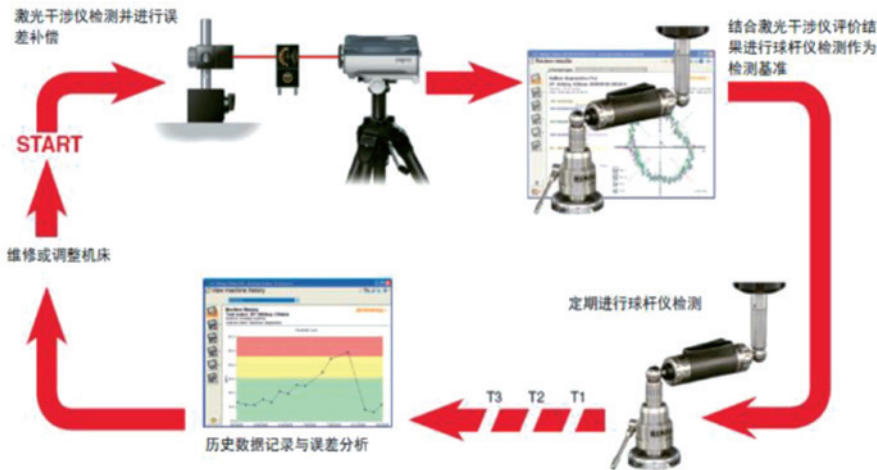
图 3：加工机床设备精度检测数字化方案示例
