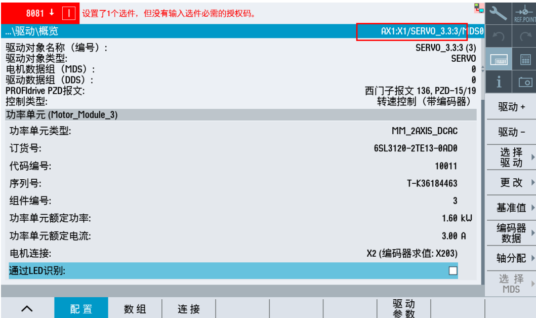
SERVO_3.3:3 分配给机床轴 AX1:X
