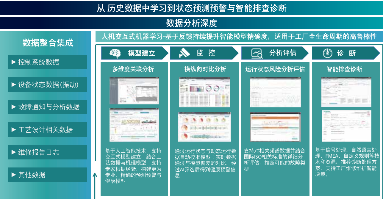
预测性分析 SiePA 的系统架构
