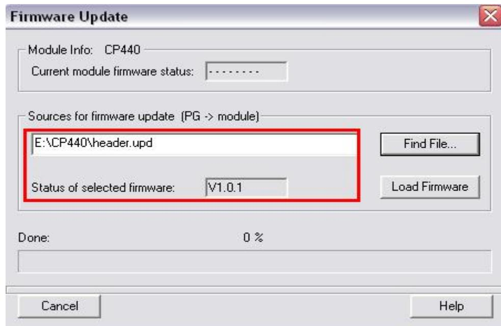
将 CPU 切换到 STOP 模式, 点击“ Load Firmware” 按钮, 开始装载到 CP440, 之后将有进度条指示固件装载的进度, 如下图所示:
