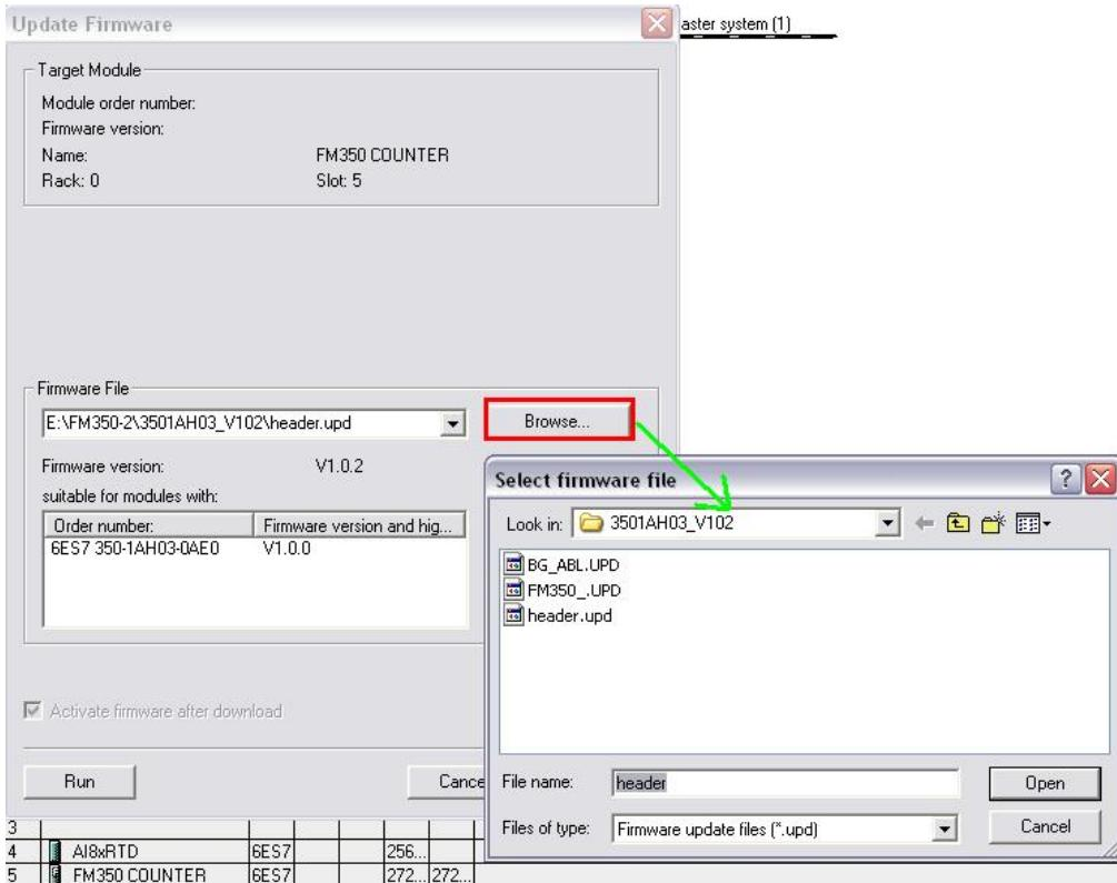
单击“Run”按钮, STEP7 将检查该模块是否能解释这个文件, 如果能, 将该文件装载到 FM 350-1; 如果更新固件时需要涉及到更改 FM350-1 的操作模式, 系统将显示操作提示, 随后 FM 350-1 将自动执行固件更新, 在更新的过程中可能会影响 CPU 停机, 如下图所示:
