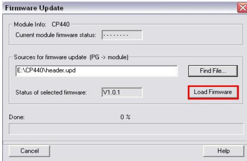
**注意:**模块在装载之前会删除原有固件, 之后会核实待装载的固件的 MLFB 是否为 CP 所接受;如果在装载过程中按下“ Discard” 按钮, 装载立即取消, 模块将无法继续操作, 固件装载成功后必须重新启动。
