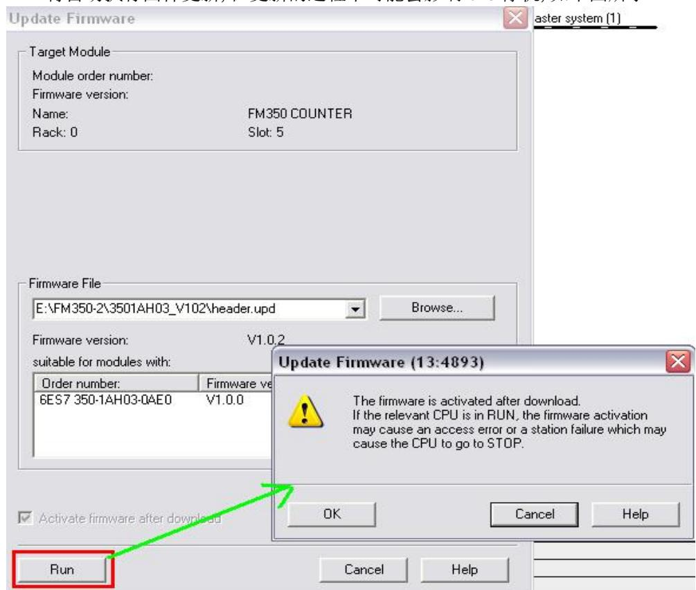
之后可以通过 HW Config (菜单选项“PLC > Module Information”，读取 FM 350-1 的 CPU 诊断缓冲区) 查看 FM350-1 启动时是否成功安装了最新的固件.
