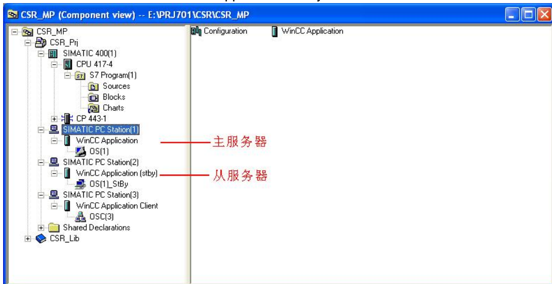
图 42 使用向导创建的项目结构
